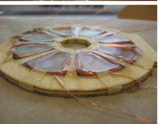
zwischen den Drähten und dem Holz. Mit einem Zahnstocher o.Ä. kann man das etwas fördern indem man sachte an den Spulen wackelt. Nach einigen Minuten kann man noch ein paar Tropfen nach kippen, so dass alle Ausschnitte bündig gefüllt sind. Lieber etwas zu wenig als zu viel.
