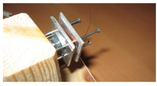
Dort legen wir den Draht nun ein und machen genau hundert Wicklungen. Nicht vergessen Anfang und Ende des Drahtes großzügig überstehen zu lassen, sonst wird das spätere Verbinden der Spulen unnötig fummelig.
